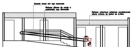
DET. RAMPAS - CORTE AA ESC. 1:75
